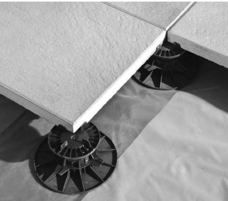
В случае установки системы на железобетонной плите террасы или балкона, напольная плитка может быть уложена с помощью опор. Системные опоры для плитки Bruk-Bet доступны версии с регулировкой высоты, облегчающей точное выравнивание плит, или плоские – с фиксированной высотой. Дополнительным элементом являются гибкие компенсационные подкладки, повышающие стабильность и звукоизоляцию поверхности.
